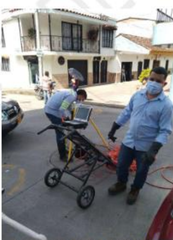
Ilustración 61. Toma de perfiles PPR.
