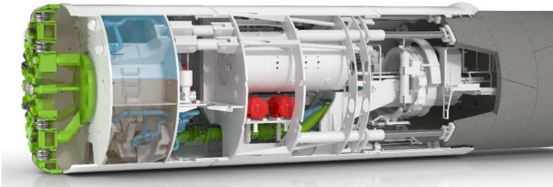
I LODOS Mixshield Ejemplo DI 3650
