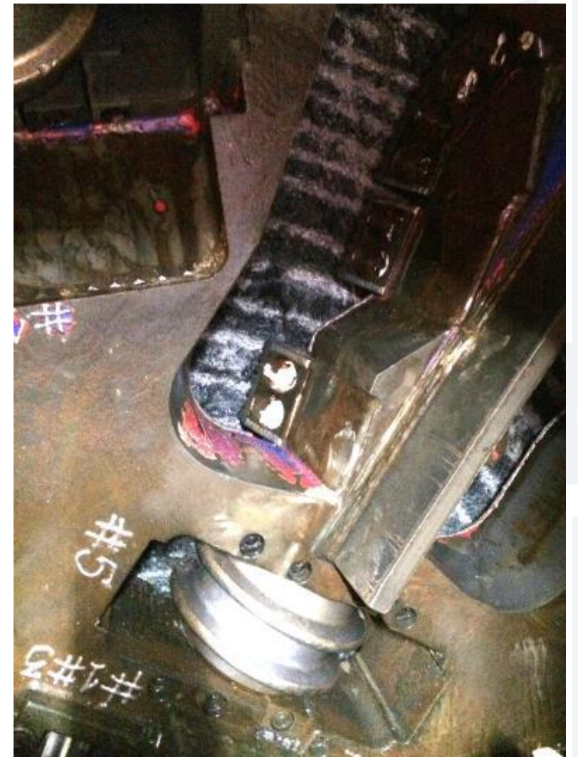
Acceso a la cámara bajo presión de aire para inspeccionar / cambiar los cortadores
