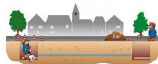
OBRA SIN ZANJA
