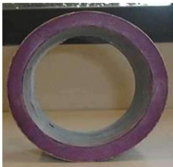
Tubería de Asbesto Cemento “Nueva”
