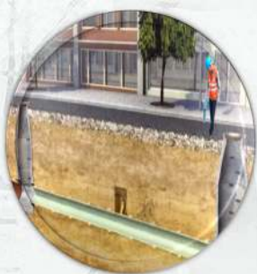
Inspección longitudinal verificación de alineamientos (PPR)
