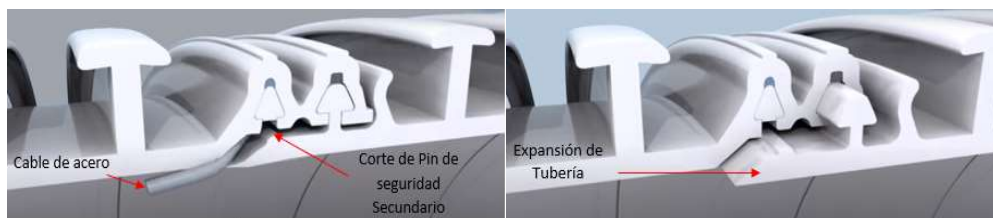
Figura 7. Perfil de tubería con corte de cable de acero. Sekisui Chemical Co.Ltd. (2020).
