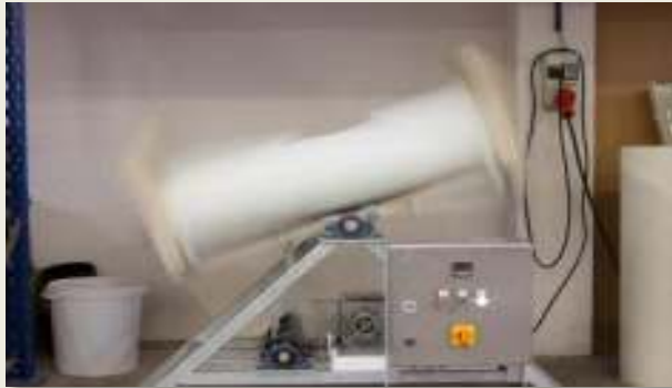
Prueba de abrasión de 100.000 ciclos Lapso simulado de uso de 50 años
