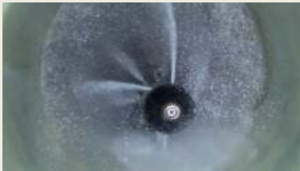
Prueba lavado de 30 ciclos con 550 \text{ N/mm}^2 (Norma: 3 ciclos con 450 \text{ N/mm}^2 ).
