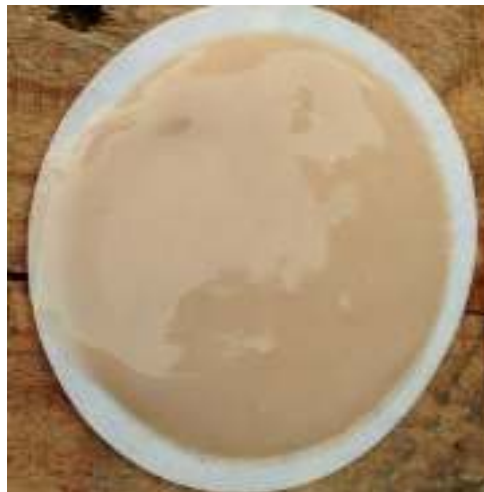
Revoque grueso, esponjoso, débil, muy permeable
