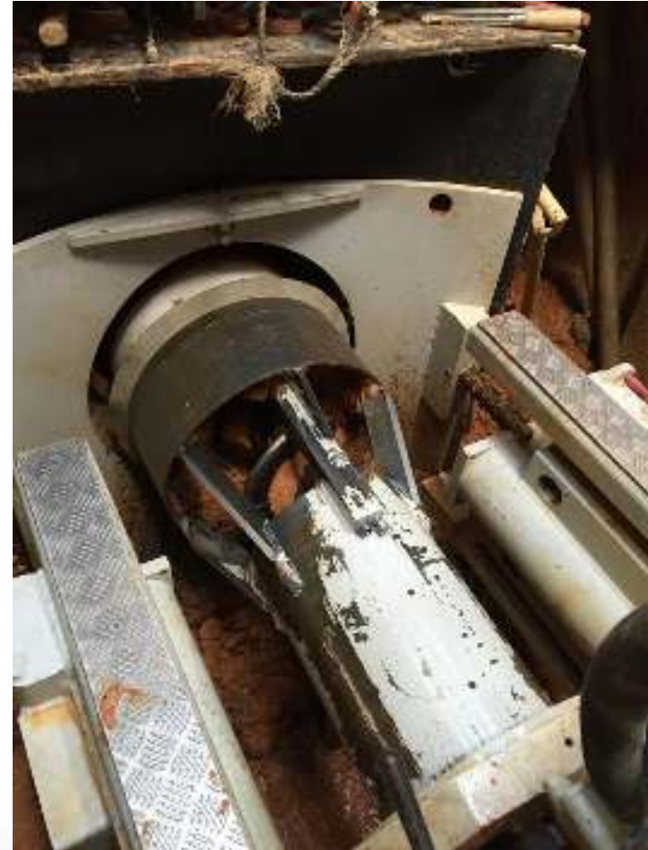
Recuperacion de Hole Opener en pozo de lanzamiento
