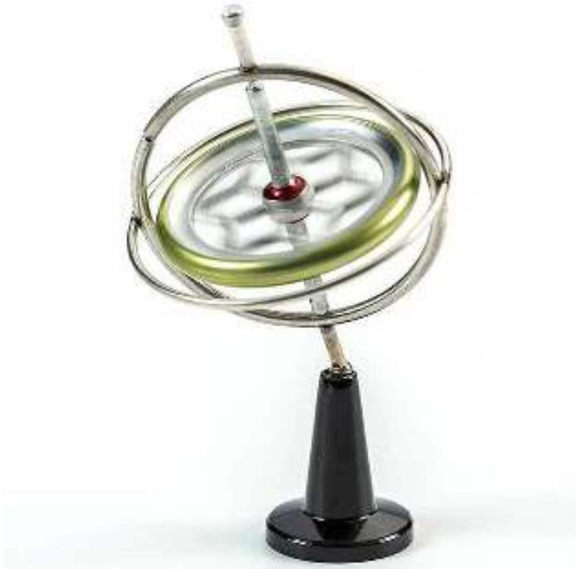
El **giroscopio** es un dispositivo utilizado para medir o mantener la orientación y la velocidad angular.
