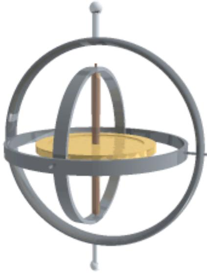
Debido a que un **giroscopio** está girando a una alta velocidad, tiene la capacidad de mantener su orientación en los tres ejes.
