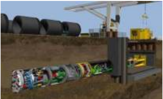
► Hincia de tubería
