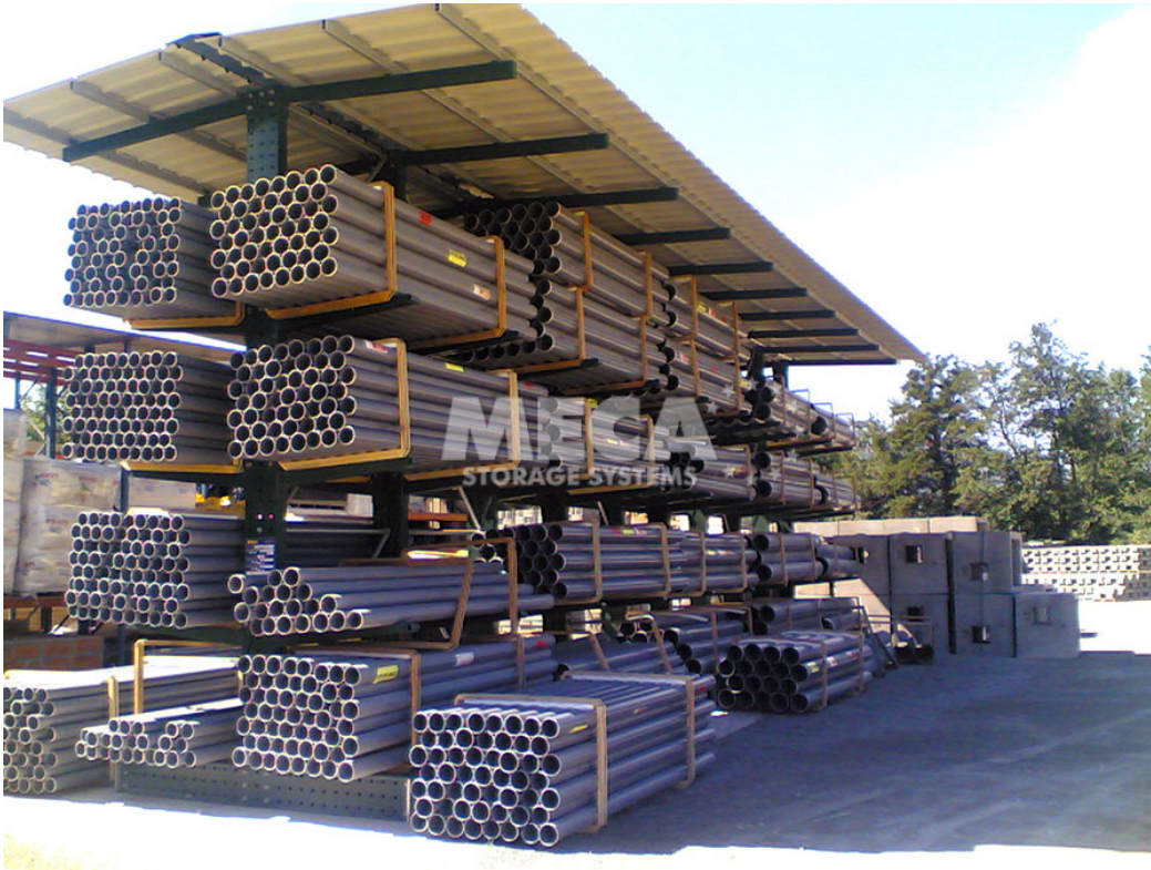
Imagen N°17: Cama de tubos (Mega Storage Systems, 2014).
