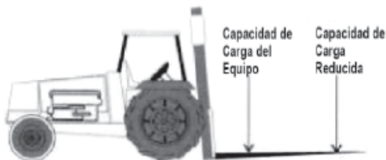
Imagen N°16: Montacargas para transporte de tuberías (Revinca, 2011).
