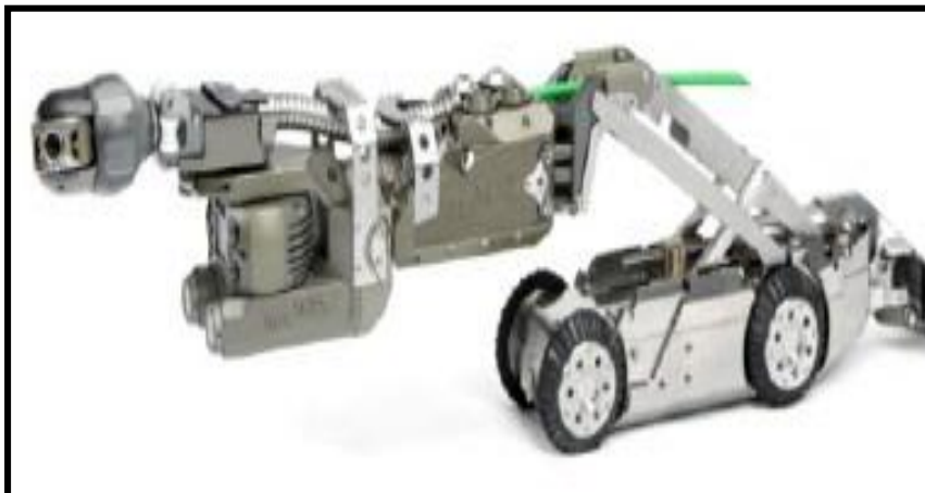
Foto 47 Tractor para inspección de tuberías dotado de CCTV Gr Hidro, 2011
