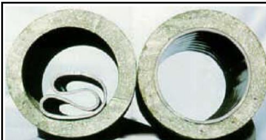
Foto 30 Tubería de polietileno antes y después de la rehabilitación. Ariaratna, 2011
