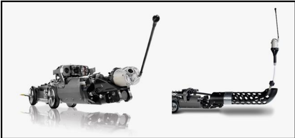
Foto 25 Robot para Inspección y diagnóstico de tuberías VE-Tecnologías sin zanja 2011
