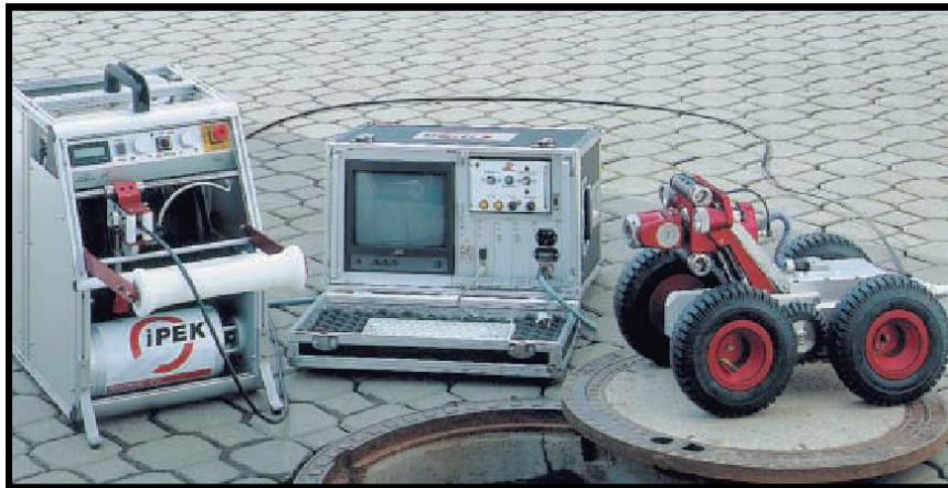
Foto 46 Equipo de inspección-diagnóstico Eaab, 2010
