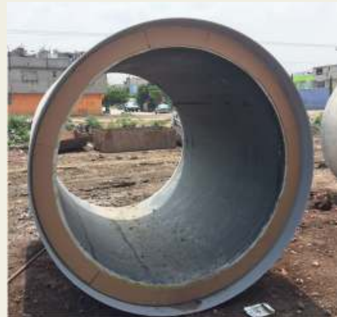
Tubería de concreto reforzado grado 3 con virola de acero
