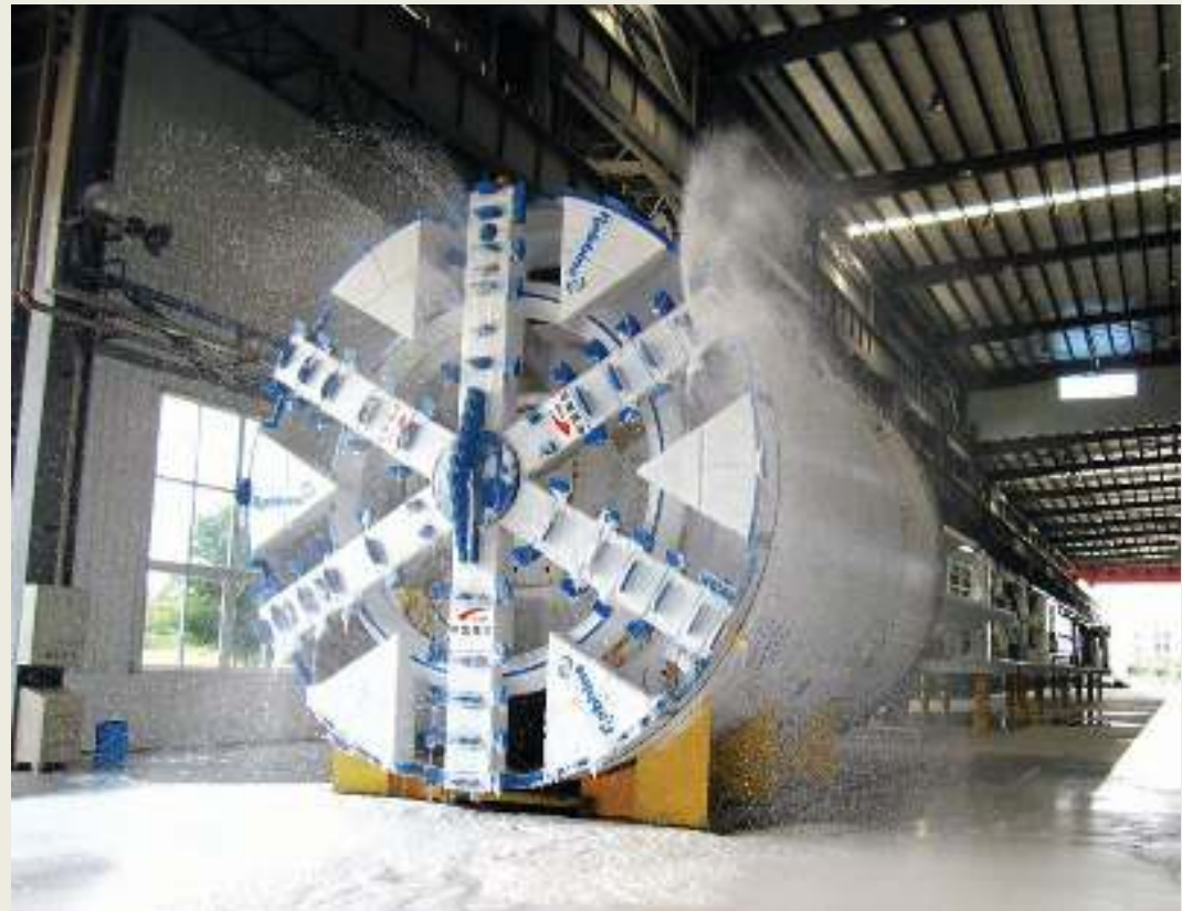
2 Máquinas EPB de 6.40 de excavación
