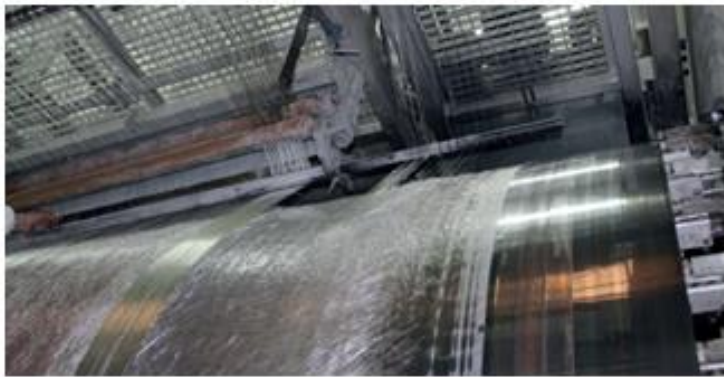
Figura 2. Conformación de la pared del tubo. (Continuous Filament Winding)
