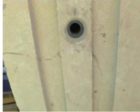
Ranuras para sellos y puerto de lubricación en Trailer pipe
