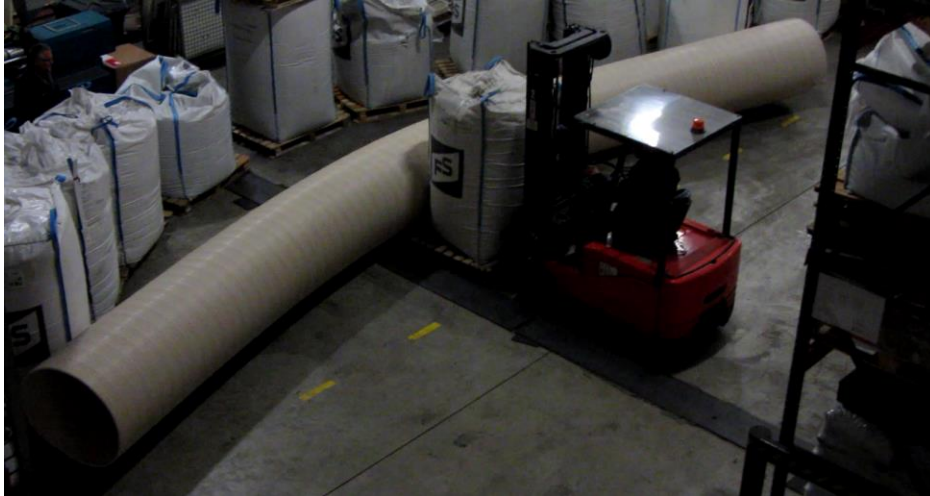
Tubería SWP-SL tipo C5 sometida a flexión por carga puntual
