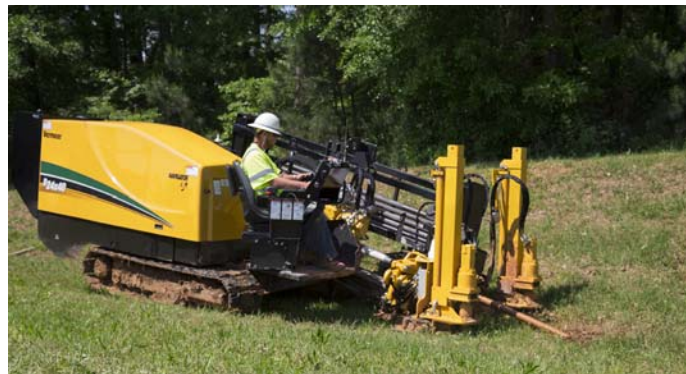
Figura 2: Una Vermeer D24x40 Series 3 – perforadora horizontal dirigida.
