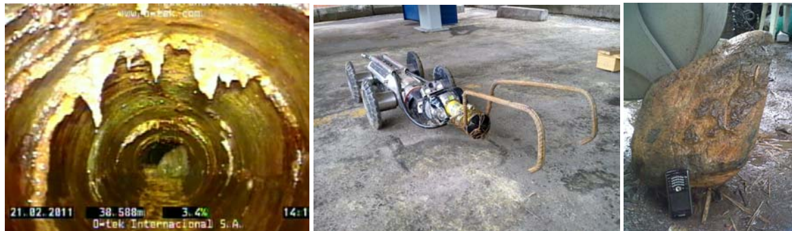
Figura 6: Adecuación del robot para retirar piedra.
