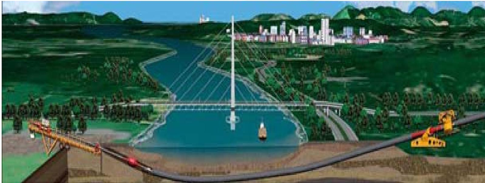
Esta tecnología opera mediante una máquina que perfora el suelo a lo largo de toda la trayectoria de la instalación, siendo orientada y seguida desde la superficie mediante un localizador que indica la posición, sin necesidad de pozos verticales, ya que la obra comienza desde la superficie.
